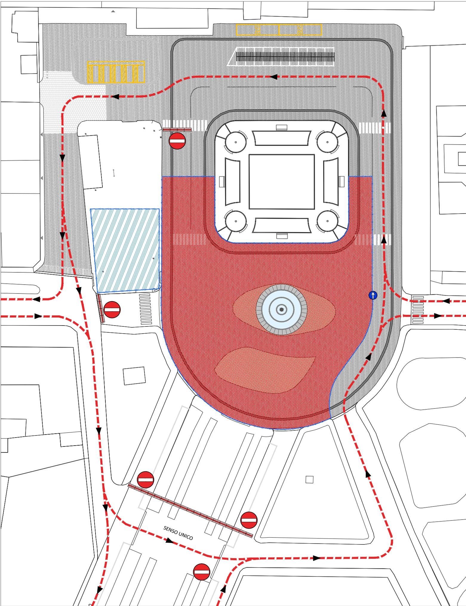
FASE 2: ESECUZIONE DELLE LAVORAZIONI (DEMOLIZIONI, REALIZZAZIONE SOTTOSERVIZI E NUOVA PAVIMENTAZIONE) - DURATA STIMATA DEI LAVORI 136 gg.
