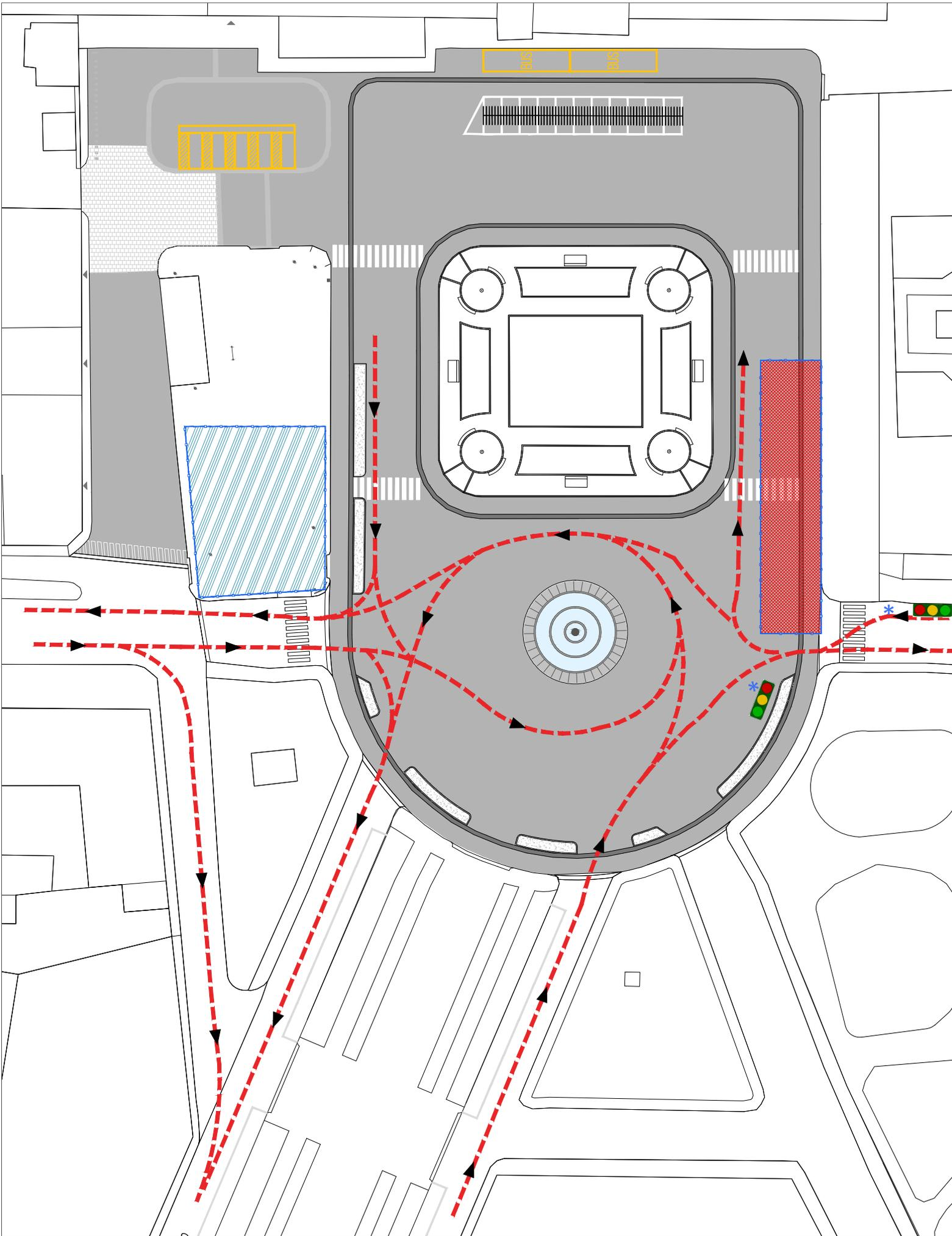
FASE 4: ESECUZIONE DELLE LAVORAZIONI (REALIZZAZIONE NUOVA PAVIMENTAZIONE) - DURATA STIMATA DEI LAVORI 20 gg. (\* DOPPIO SENSO ALTERNATO CON REGOLAZIONE SEMAFORICA)
