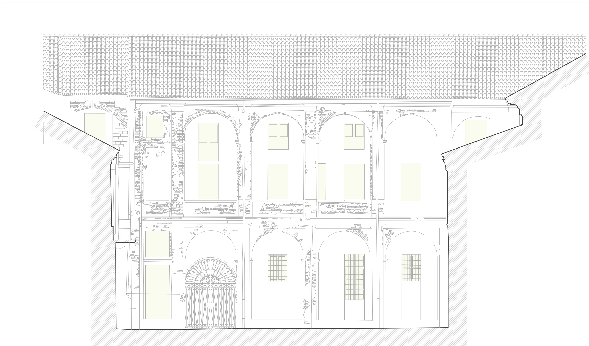
SOSTITUZIONE ED EVENTUALE RIPRISTINO DEGLI INFESSI
