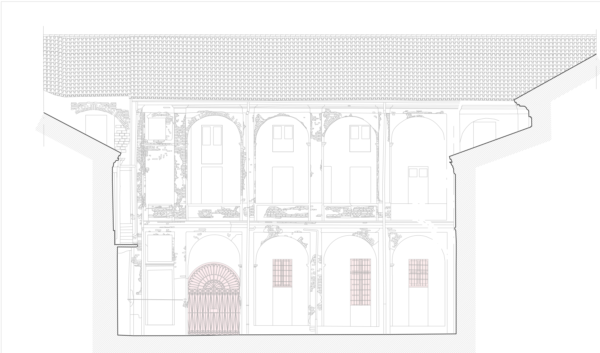
RIMOZIONE ED EVENTUALE RIPRISTINO DELLE INFERRIATE
