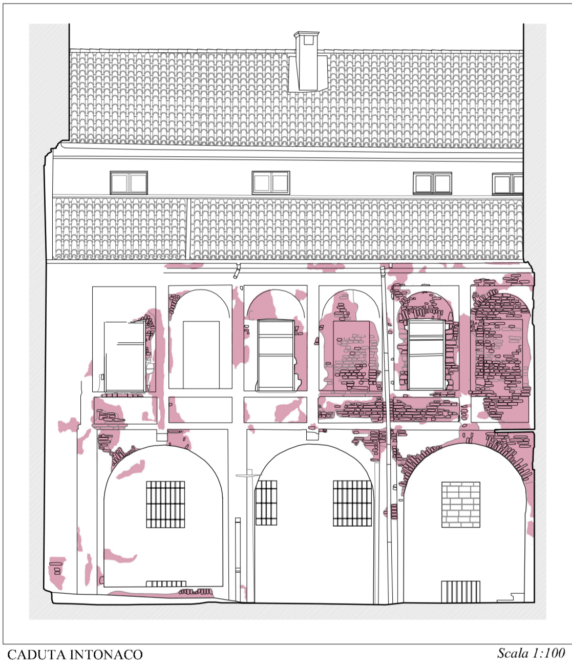
CADUTA INTONACO Scala 1:100
