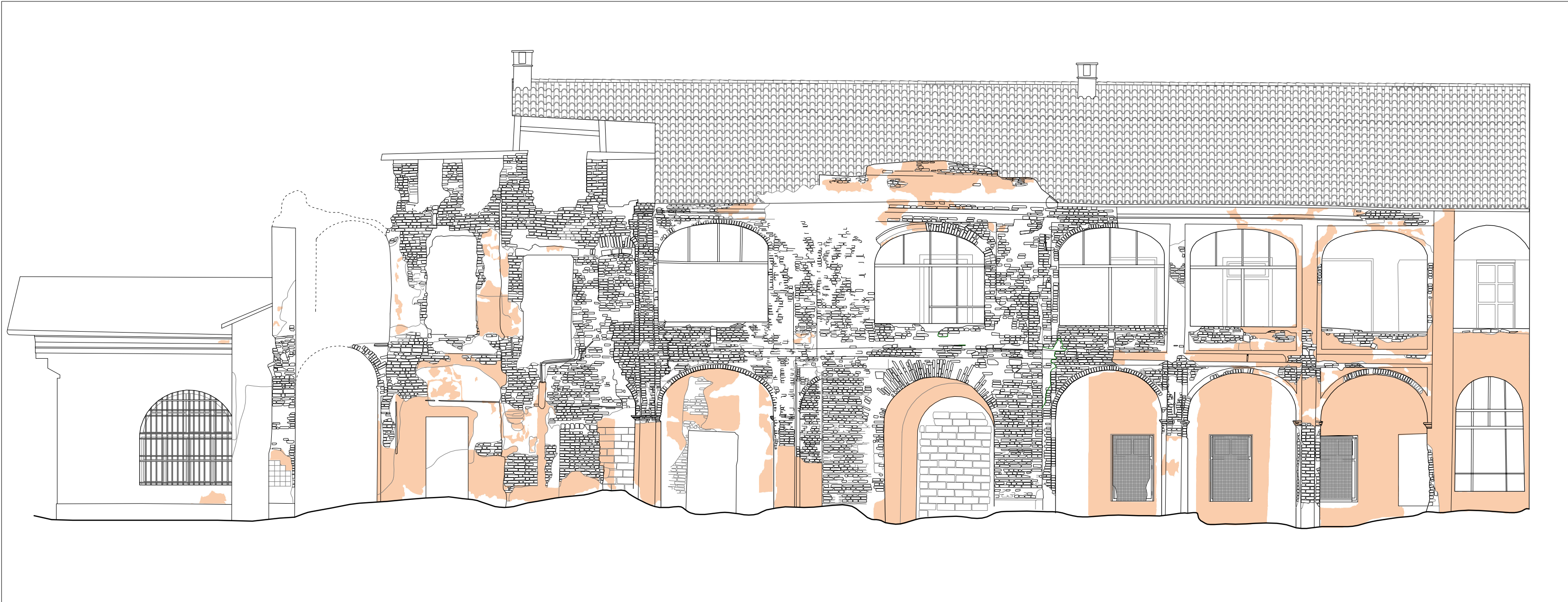
ABRASIONE INTONACO
