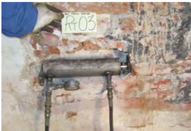
Fotografia del pistone all'interno della cavità creata nella muratura
