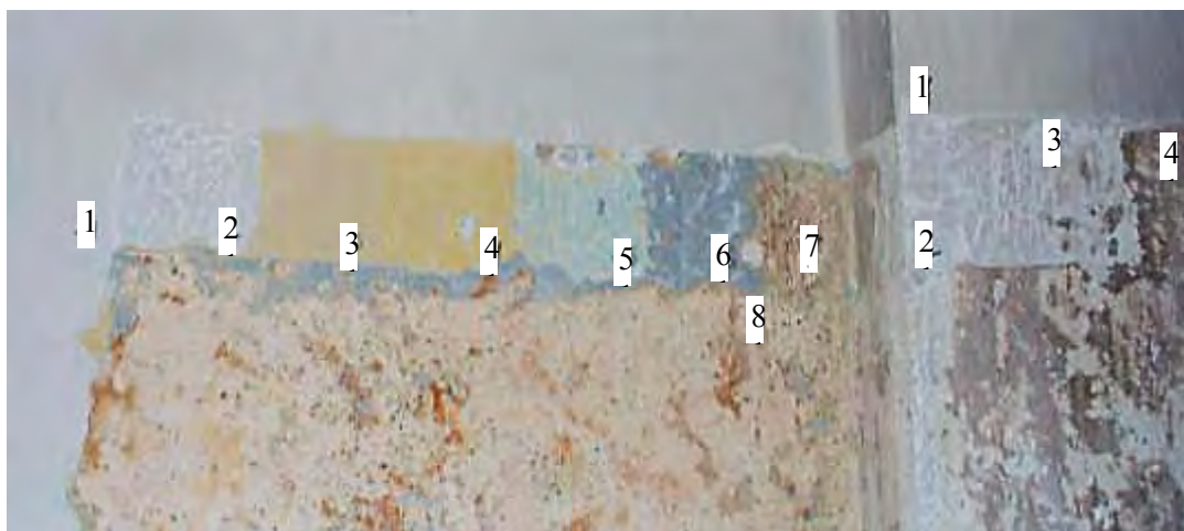
Foto 11: saggio 8 stratigrafia sovrapposizioni in volta
