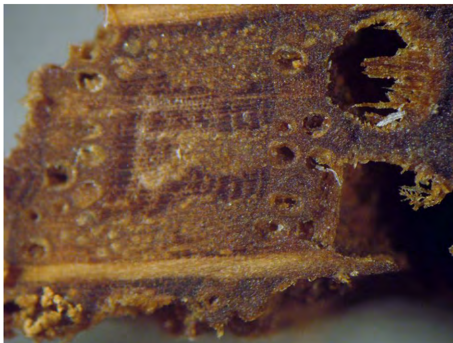
Foto 3. Campione LAB. 01. Preparato visto allo stereomicroscopio. In evidenza nella foto: Listello ligneo di colore brunastro di matrice eteroxila.
